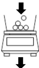
⇒ Posizionare il materiale da pesare sul piattello della bilancia o inserirlo nel contenitore utilizzato per la pesata.
